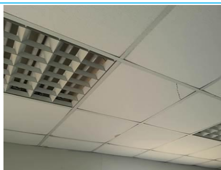
Matériaux : Z08 - Bureau - Faux plafond Prélèvement : P010 Description : dalle de faux plafond Localisation : Bureau - Faux plafond Résultat : Absence d'amiante
